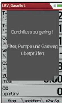
Optionale Durchflussüberwachung (z. B. Filterverschmutzung)
