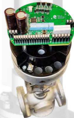
**Stellungsregler baelz 7022** eingebaut im digitalen Fail-Safe Motorhubantrieb baelz 373-E07-OSD/OSZ
