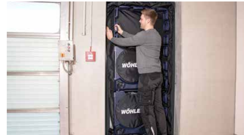
Einbau von einem oder zwei Geräten in Fenster und Türen durch ausgefeiltes Klammersystem. Fehlen Fenster-/oder Türrahmen noch, kann die Folie in einen optional erhältlichen Zusatz-Einbaurahmen eingesetzt werden.
