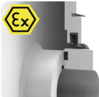
Hochwertiges Dichtungssystem mit Lippendichtung aus Fluorkautschuk und Wellenschutzhülse aus hochkorrosionsbeständiger Nickelbasislegierung. Beständig gegen alle im Chemieanlagenbau üblichen anorganischen Säuren, Laugen und Kohlenwasserstoffe. Sehr gut geeignet für feuchtes Fördermedium.
