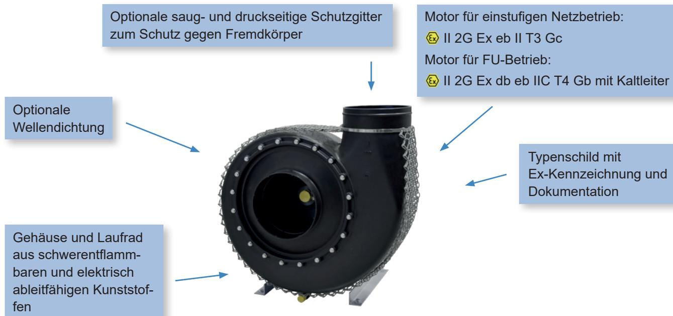
Sie sehen auf dem Typenschild des Ventilators eine dauerhaft lesbare Kennzeichnung des Explosionsschutzes. Die folgende Abbildung erläutert die Kennzeichnung von Betriebsmitteln für den Ex-Bereich:
