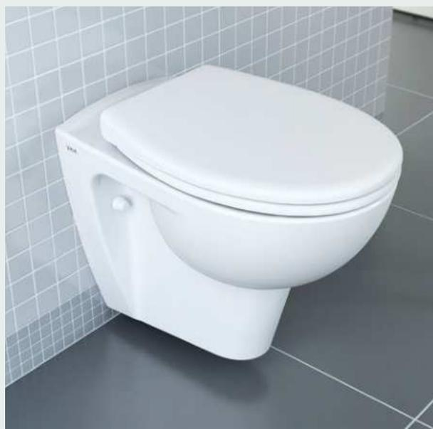
Wand-WC Vitra Flush 2.0 Tiefspüler + 6 cm, für barrierefreie Anwendungen geeignet, nach DIN 18040, ohne Spülrand, mit sichtbarer Befestigung, seitlich offen, 3/6 Liter Spülvolumen
