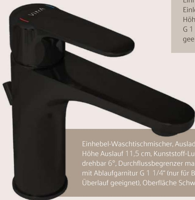
Einhebel-Waschtischmischer, Ausladung 13,5 cm, Höhe Auslauf 11,5 cm, Kunststoff-Luftsprudler, drehbar 6°, Durchflussbegrenzer max. 5 l/min., mit Ablaufgarnitur G 1 1/4" (nur für Becken mit Überlauf geeignet), Oberfläche Schwarz Matt
