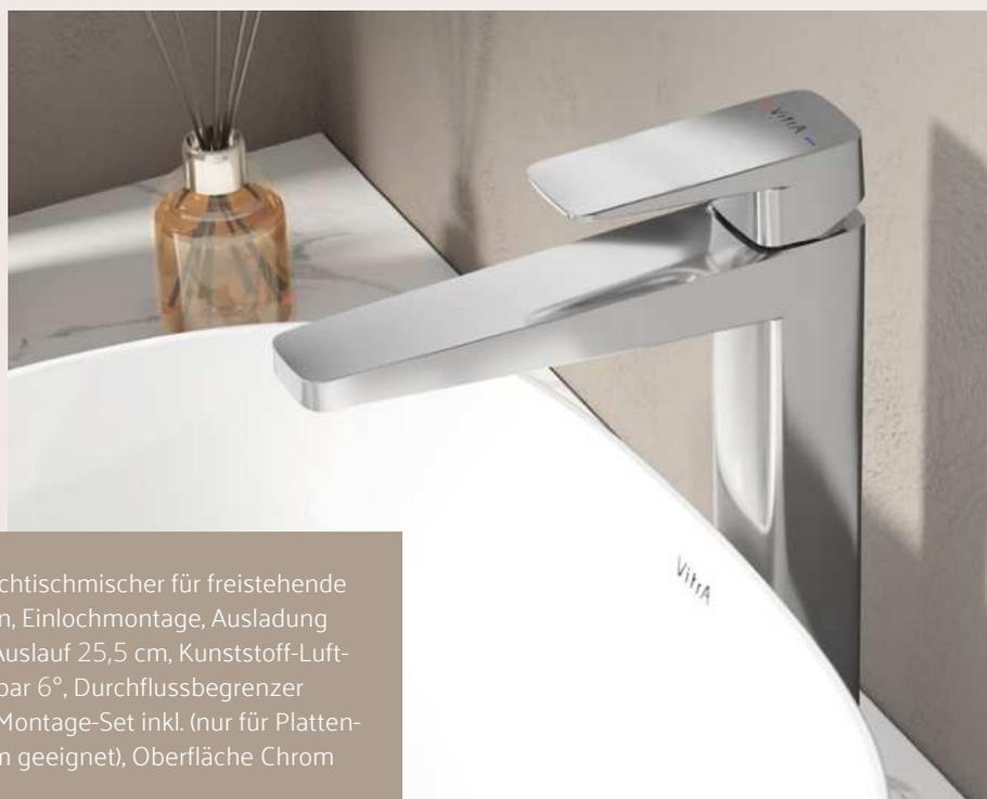
Einhebel-Waschtismischer für freistehende Aufsatzschalen, Einlochmontage, Ausladung 18 cm, Höhe Auslauf 25,5 cm, Kunststoff-Luftsprudler, drehbar 6°, Durchflussbegrenzer max. 5 l/min., Montage-Set inkl. (nur für Plattenstärke bis 3 cm geeignet), Oberfläche Chrom
