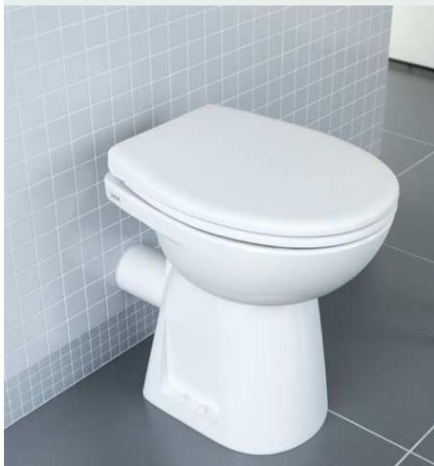
Stand-WC Vitra Flush 2.0 Tiefspüler + 6 cm, für barrierefreie Anwendungen geeignet, nach DIN 18040, ohne Spülrand, mit 4 Befestigungspunkten, 3/6 Liter Spülvolumen, Abgang waagrecht
