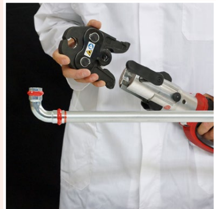
Fig. 26 | Ausrüstung der Presswerkzeuge Pressing tool assembly
