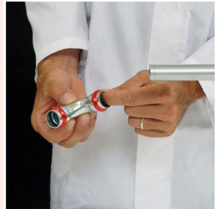
Fig. 23 | Prüfung der Präsenz und der Positionierung der O-Ringe Checking the presence and positioning of o-rings
