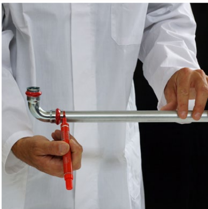
Fig. 24 | Einsetzen der Rohre in die Fittings und Kennzeichnung Inserting pipes into fittings and marking the correct position
