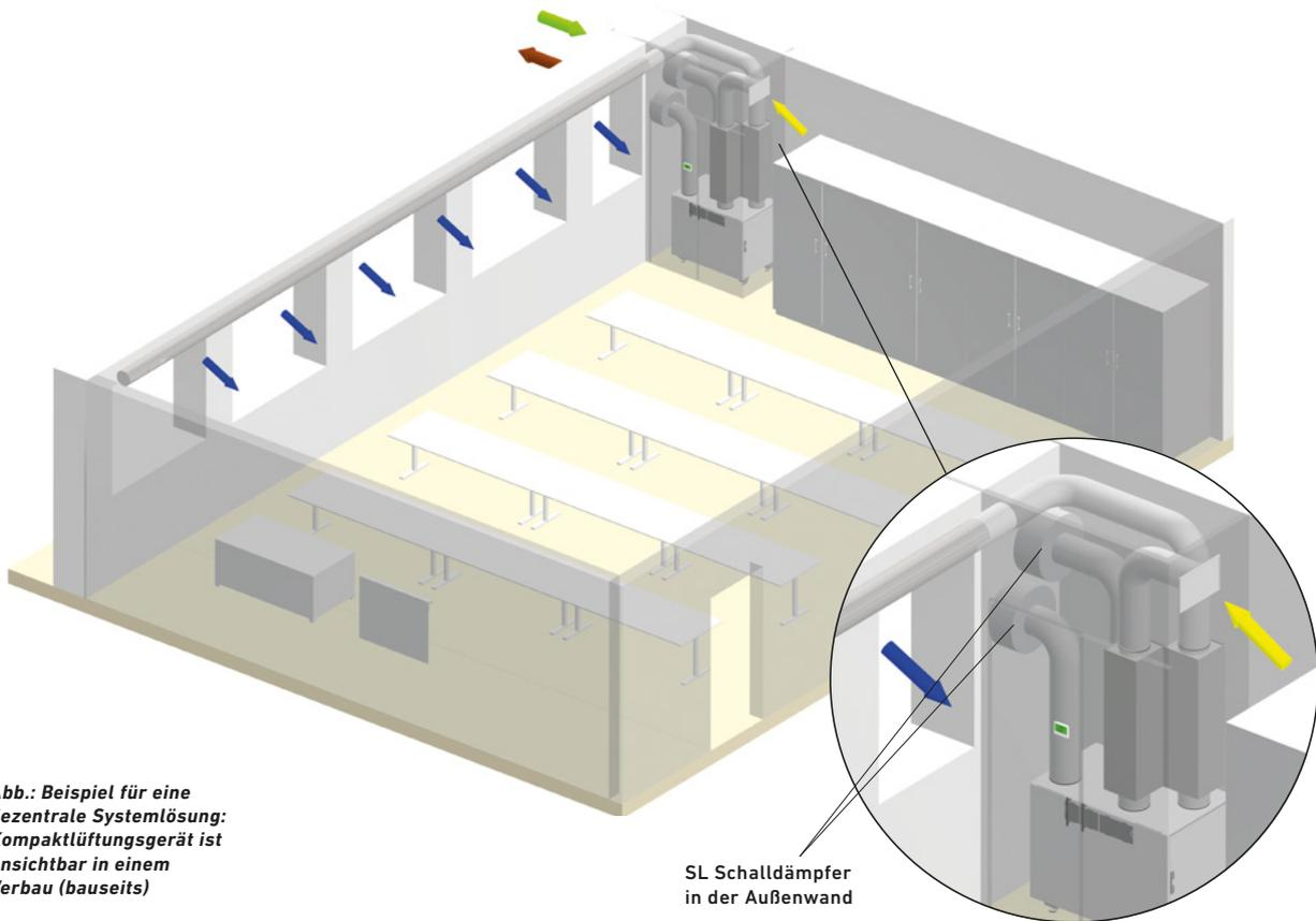
**Abb.: Beispiel für eine dezentrale Systemlösung: Kompaktlüftungsgerät ist unsichtbar in einem Verbau (bauseits)**
