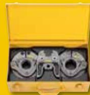
REMS Pressringe (PR-3S) mit 3 an einem gelenkigen Ring schwenkbar gelagerten Presssegmenten für anspruchsvolle Pressungen großer Dimensionen. Optimale Pressung durch radial gesteuerte Bewegung der Presssegmente. Presskontur M für Pressfitting-Systeme Geberit Mapress und geeignete andere Systeme.
