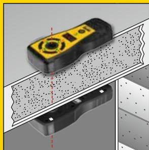
**REMS Detect B – zur exakten Bestimmung der Ein- und Austrittsmittelpunkte bei Durchgangsbohrungen.**
