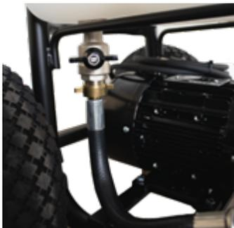
Absperrhahn aus Metall, stoßsicher positioniert
