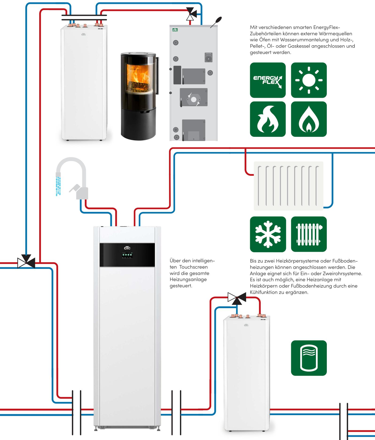
Mit verschiedenen smarten EnergyFlex-Zubehörteilen können externe Wärmequellen wie Öfen mit Wasserummantelung und Holz-, Pellet-, Öl- oder Gaskessel angeschlossen und gesteuert werden.
