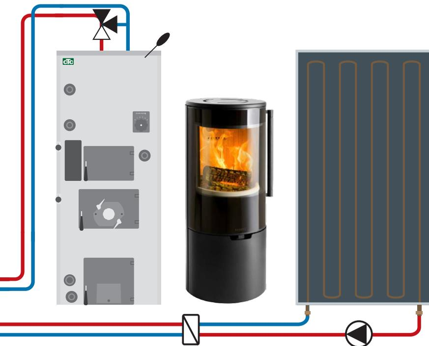
Mit verschiedenen intelligenten EnergyFlex-Zubehörteilen können externe Wärmequellen wie Öfen mit Wasserummantelung, Solarkollektoren und Holz-, Pellet-, Öl- oder Gaskessel angeschlossen und gesteuert werden.
