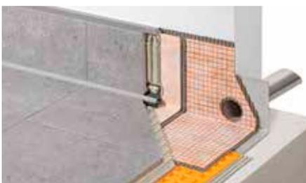
Schlüter-KERDI-DRAIN-SP-E ist ein Edelstahl-Speier zur Entwässerung von Balkon- und Terrassenflächen, die durch eine Brüstung begrenzt werden. Auf dem großen Klebeflansch wird die mitgelieferte Schlüter-KERDI Manschette als Dichtanschluss verklebt und dadurch eine einfache und sichere Anbindung von Verbundabdichtungen gewährleistet.
