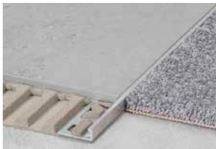
Schlüter-SCHIENE-A ist ein dekoratives Profil aus Aluminium, das in unterschiedlich eloxierten und veredelten Oberflächen erhältlich ist. Sein Abschlusschenkel im 87°-Winkel schützt die Fliesen sicher vor mechanischer Beschädigung. Durch den Fugensteg wird eine definierte Fugenkammer zur Fliese vorgegeben.
