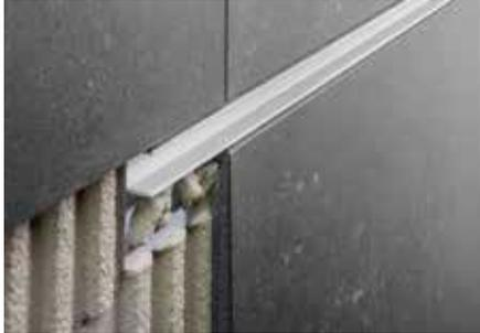
Schlüter-DECO-SG ist ein dekoratives Profil zur Fugengestaltung in Fliesenbelägen. Es bildet wahlweise eine 12 mm bzw. 15 mm breite Schattenfuge aus. Die Fuge eignet sich ideal zur Aufnahme und Fixierung von Glaselementen im Boden- und Wandbereich. (Produktdatenblatt 2.16)
