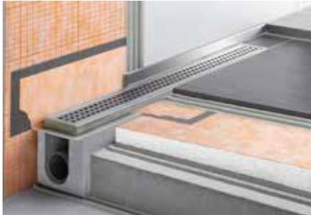
Schlüter-KERDI-LINE-H ist ein komplettes Set für lineare bodenebene Duschen mit einem horizontalen Ablauf. Es ist universell für den zentralen Einbau in einer Fläche oder im Wandbereich einsetzbar. Auf dem umlaufenden Klebeflansch des Rinnenkörpers ist werkseitig eine Manschette aus Schlüter-KERDI fest verklebt. Sie dient zum sicheren Anschluss des Rinnenkörpers an die Verbundabdichtung sowohl im Bodenbereich als auch an aufgehenden Wänden.
