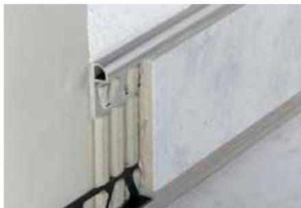
Schlüter-PRG ist ein dekoratives Profil aus farbigem PVC für symmetrisch gerundete Wandaußenecken an Fliesenbelägen sowie Sockel- und Belagsabschlüsse, das die Fliesenkanten vor mechanischer Beschädigung schützt. (Produktdatenblatt 2.1)
