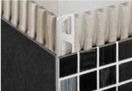
Schlüter-FINEC-E ist ein hochwertiges Abschlussprofil aus Edelstahl für die Außenkanten von Fliesenbelägen, Glasmosaiken oder Putz-/Spachteloberflächen. Das Profil schützt den Belagsrand vor mechanischen Schäden und bildet eine elegante, schmale Eckausprägung. FINEC-E aus Edelstahl eignet sich auch im Treppenbereich als schmaler Kantenschutz für Fliesen und Beschichtungssysteme. (Produktdatenblatt 2.17)
