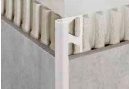
Schlüter-RODEC-AC ist ein symmetrisch gerundetes Profil mit Fugensteg für Wandaußenecken und Belagsabschlüsse aus Aluminium mit einer farbigen Beschichtung. Durch den Fugensteg wird eine definierte Fugenkammer zur Fliese vorgegeben. (Produktdatenblatt 2.1)
