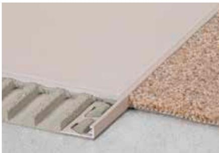
Schlüter-SCHIENE-AC ist ein dekoratives Profil aus farbig beschichtetem Aluminium. Sein Abschlusschenkel im 87°-Winkel schützt die Fliesen sicher vor mechanischer Beschädigung. Durch den Fugensteg wird eine definierte Fugenkammer zur Fliese vorgegeben.
