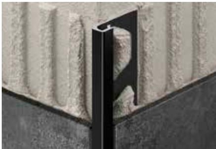
Schlüter-QUADEC-AC ist ein hochwertiges Abschlussprofil aus farbig beschichtetem Aluminium für Wandaußenecken und Abschlüsse von Fliesenbelägen. Die Sichtfläche des Profils bildet eine rechtwinklige Ausprägung der Außenecke. Durch den Fugensteg wird eine definierte Fugenkammer zur Fliese vorgegeben.
