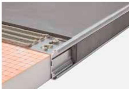
Schlüter-RODEC-STEP-CT ist ein Kantenprofil mit Fugensteg für Arbeitsplatten oder Ablagen, die einen keramischen Belag erhalten. In dem Freiraum des Profils können der Belag der Oberseite wieder aufgegriffen oder andere dekorative Elemente eingebracht werden.
