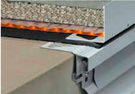
Schlüter-BARA-RWL ist ein Randprofil mit Entwässerungslöchern aus beschichtetem Aluminium für den Randbereich von Balkonen und Terrassen. Es eignet sich besonders für den Abschluss von Balkon- und Terrassenbelägen, die lose auf Kies oder Stelzlager verlegt werden.
