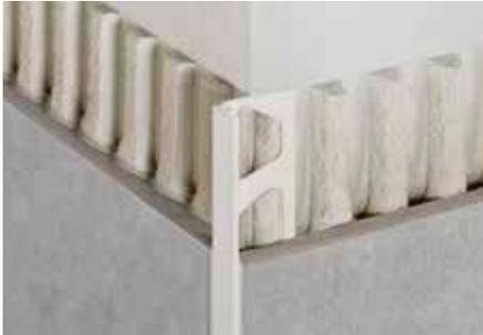
Schlüter-JOLLY-P aus farbigem PVC ist ein dekoratives Profil für Wandaußenecken an Fliesenbelägen sowie Sockel- und Belagsabschlüsse, das die Fliesenbeläge vor mechanischer Beschädigung schützt. Durch den Fugensteg wird eine definierte Fugenkammer zur Fliese vorgegeben.
