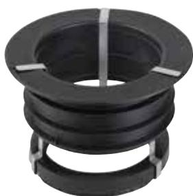
Schlüter-KERDI-DRAIN-ZBS ist eine Durchgangsdichtung mit Brandschutz-Funktion. Sie dient, alternativ zur Vermörtelung, in Verbindung mit dem vertikalen Bodenablauf-Set KD BAV 50 GVB oder der vertikalen Edelstahl-Linienentwässerung KLV 50 G2 als Brandabschottung der Kernlochbohrung (Ø 160 mm) und verhindert die Bildung von Schallbrücken. Gilt nur in Verbindung mit KD BS bzw. KL BS als zugelassener Brandschutz.
