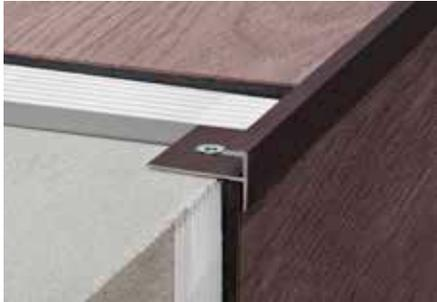
Schlüter-VINPRO-STEP ist ein Abschluss- und Kantenschutzprofil für elastische Beläge (z. B. LVT, Designbeläge) auf Treppenanlagen. Das Profil weist eine rechteckige Form auf und ist mit einem rutschhemmend gerippten Abdeckflansch ausgestattet.
