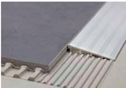
Schlüter-RENO-RAMP-K ist ein Profil für den stufenlosen Übergang von stark belasteten Fliesenbelägen zu einem angrenzenden niedrigen Belagsmaterial. Das Profil kann zum nachträglichen Höhenausgleich zwischen Belagsmaterial und Untergrund verklebt werden.
