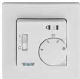
Schlüter-DITRA-HEAT-E-R4 ist ein analoger Temperaturregler für die elektrische Temperierung von Boden- und Wandbelägen mit Schlüter-DITRA-HEAT-E. Der benutzerfreundliche Regler verfügt über einen Ein-/Aus-Schalter sowie eine Wählscheibe zur Einstellung des Temperatur-Sollwertes. Ein Reservefühler ist im Lieferumfang enthalten. (Produktdatenblatt 6.6)
