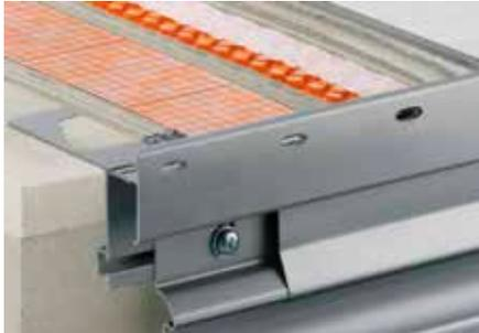
Schlüter-BARA-RTKE ist ein Randprofil mit Tropfkante zur Verlegung auf einen fertigen Gefälleestrich. Das Profil hat eine Aufnahmevorrichtung zur Befestigung des Rinnensystems Schlüter-BARIN. Das Profil BARA-RTKE ist besonders gut für den Konstruktionsaufbau mit der Verbunddrainage Schlüter-DITRA-DRAIN geeignet. Durch die gelochte Aufkantung erhält man einen sauberen Fliesenabschluss.
