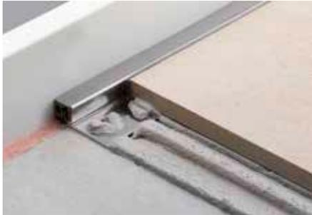
Schlüter-DILEX-KSA ist ein Anschlussprofil mit Kantenschutz, bestehend aus einem seitlichen Befestigungsschenkel aus Aluminium oder Edelstahl, der mit einer auswechselbaren Dehnzone aus weichem Kunststoff verbunden ist. Es dient zum Anschluss von Belagsflächen an feste Einbauteile wie z. B. Fensterelemente.
