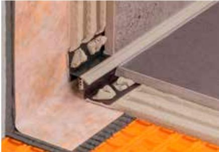
Schlüter-DILEX-EK ist ein zweiteiliges Profil aus Hart-/Weich-Kunststoff mit einer Nut- und Federverbindung und integrierter Fliesenkammer. Es dient zur Herstellung dauerhaft flexibler und wartungsfreier Randfugen als Boden-/Wand- bzw. Sockelanschluss.
