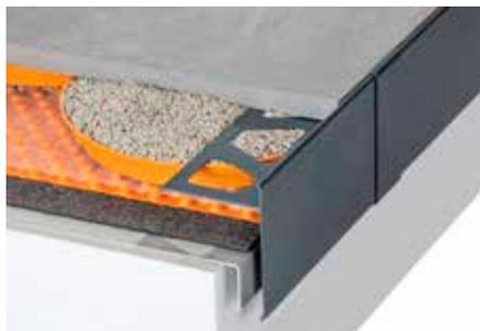
Schlüter-BARA-RTC ist ein T-förmiges Abschlussprofil aus farbig beschichtetem Aluminium zur Abdeckung exponierter Ränder von Balkonen und Terrassen. Es ist ideal geeignet, um 20-mm-Fliesen in Verbindung mit Plattenlagern der Schlüter-TROBA-Reihe zu verlegen. Der obere Schenkel schützt den Rand der Fliesen, während der untere Schenkel die Aufstelzung abdeckt und als Tropfkante dient.
