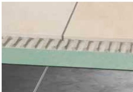
Schlüter-REFLEECE ist ein Vlies aus recyceltem PET mit einer rückseitig aufgetragenen Haftbeschichtung. Es eignet sich zur Herstellung wieder aufnehmbarer Bodenbeläge aus Fliesen und Naturstein. Die selbsthaftende Rückseite ist bei einem Rückbau leicht vom Untergrund ablösbar und verursacht keine Schäden am bestehenden Unterboden.
