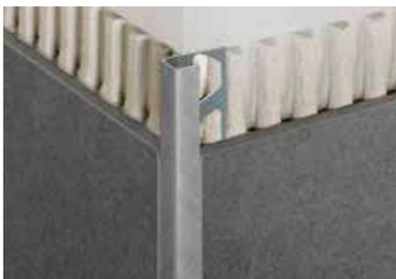
Schlüter-QUADEC-A ist ein hochwertiges Abschlussprofil aus eloxiertem Aluminium für Wandaußenecken und Abschlüsse von Fliesenbelägen. Die Sichtfläche des Profils bildet eine rechtwinklige Ausprägung der Außenecke. Durch den Fugensteg wird eine definierte Fugenkammer zur Fliese vorgegeben.
