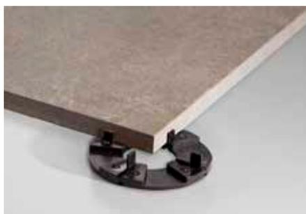
Schlüter-TROBA-LEVEL-PL 10 sind stapelbare Plattenlager zum Aufstellen von Plattenelementen – unabhängig von Format und Dicke. Sie sind aus einem schalldämmend wirkenden Spezialkunststoff gefertigt und können direkt auf der Abdichtung verlegt werden. Die 3 mm dicken Stege ermöglichen ein homogenes Fugenbild und können Bewegungen im Belag aufnehmen. TROBA-LEVEL-PL 10 können bis zu einer Höhe von 200 mm gestapelt werden und sind mit anderen Plattenlagern der Produktserie kombinierbar.
