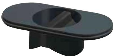
Schlüter-KERDI-LINE-GTO ist ein Geruchsverschluss mit Silikon-Trockenklappe. Er kann bei selten genutzten Ablaufsystemen (z. B. in Ferienwohnungen) anstelle des serienmäßigen Geruchsverschlusses eingesetzt werden und verhindert eine Geruchsbildung infolge der Austrocknung der Geruchsverschlusseinheit. Mit einer Ablaufleistung von mind. 0,4 l/s kann er dort auch dauerhaft die serienmäßige Geruchsverschlusseinheit ersetzen.
