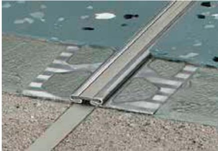
Schlüter-DILEX-EKSB ist ein Bewegungsfugenprofil mit Kantenschutz für Beschichtungen und sonstige dünn-schichtige Bodenbeläge. Es besteht aus seitlichen Befestigungsschenkeln aus Edelstahl, die mit einer nichtauswechselbaren Dehnzone aus weichem Kunststoff verbunden sind.
