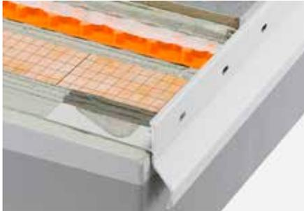
Schlüter-BARA-RKKE ist ein T-förmiges Abschlussprofil mit kurzer Tropfkante zur Verlegung auf einen fertigen Gefälleestrich. Das Profil BARA-RKKE ist besonders gut für den Konstruktionsaufbau mit der Verbunddrainage Schlüter-DITRA-DRAIN geeignet. Durch die gelochte Aufkantung erhält man einen sauberen Fliesenabschluss.
