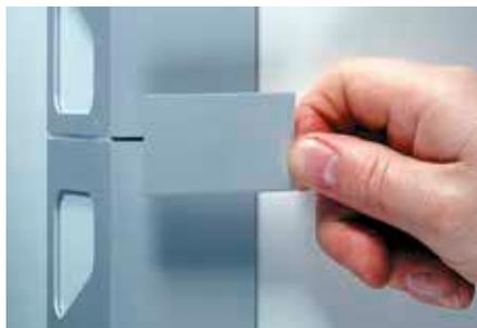
Schlüter-BARA-STU sind dünne Aluminium-Blechstreifen, die mit einer Schere auf Länge geschnitten und mit Schlüter-KERDI-FIX als Stoßüberdeckung der BARA-Profilserie verklebt werden können.
