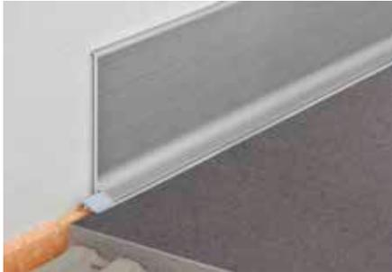
Schlüter-DESIGNBASE-SL-A ist ein Profil aus hochwertigem, beschichtetem oder eloxiertem Aluminium zur schnellen Erstellung von formschönen Sockelbekleidungen. Das Profil wird einfach mit einem geeigneten Kleber im Wandbereich fixiert. Optional kann das Profil mit einer als Zubehör erhältlichen Dichtlippe ausgestattet werden, um die Randfuge vor dem Eindringen von Feuchtigkeit zu schützen und die Übertragung von Trittschall zu reduzieren.
