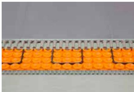
Schlüter-DITRA-HEAT ist eine Polypropylenbahn mit einer hinterschnittenen Noppenstruktur, die rückseitig mit einem Trägervlies versehen ist. Sie ist ein universeller Untergrund für Fliesenbeläge mit den Funktionen Entkopplung, Verbundabdichtung sowie Dampfdruckausgleich und kann systemkonforme Heizkabel zur Boden- und Wandbeheizung aufnehmen. (Produktdatenblatt 6.4)
