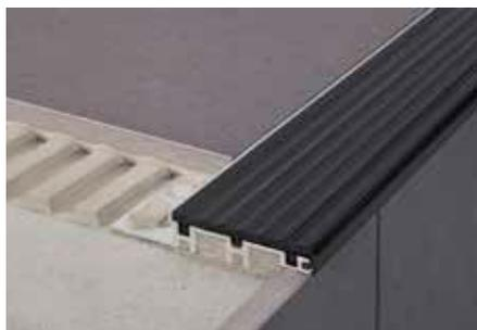
Schlüter-TREP-S/-B sind Treppenprofile aus Aluminium oder Edelstahl mit einer eingeklemmten auswechselbaren Auftrittsfläche aus rutschhemmendem Kunststoff. Sie sind wahlweise mit breiter (TREP-B) oder schmaler (TREP-S) Auftrittsfläche erhältlich. (Produktdatenblatt 3.2)
