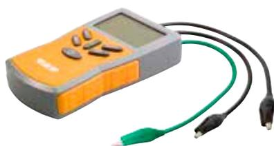
Schlüter-DITRA-HEAT-E-CT ist ein Testgerät zur Messung und Überprüfung des Widerstandes der elektrischen Heizkabel Schlüter-DITRA-HEAT-E-HK und -CHC sowie der den Schlüter-DITRA-HEAT-E Reglern beigefügten Fernfühler. Während der gesamten Einbauphase überwacht das Gerät den Widerstand der Heizkabel. Im Schadensfall wird der Verarbeiter durch ein akustisches Signal alarmiert. (Produktdatenblatt 6.6)
