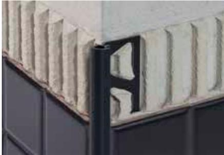
Schlüter-RODEC-PRO ist ein dekoratives Profil aus farbigem PVC für symmetrisch gerundete Wandaußenecken an Fliesenbelägen sowie Sockel- und Belagsabschlüsse, das die Fliesenkanten vor mechanischer Beschädigung schützt. Durch den Fugensteg wird eine definierte Fugenkammer zur Fliese vorgegeben.
