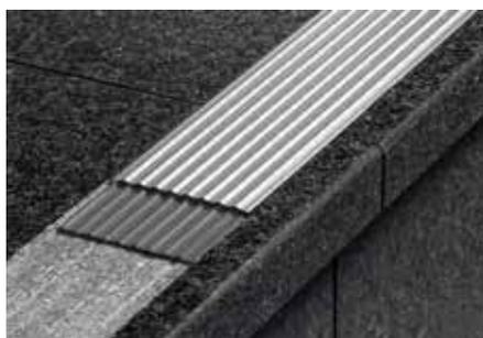
Schlüter-TREP-EFK ist ein Profil aus Edelstahl mit spezieller rutschhemmender Profilierung zur sicheren und optisch ansprechenden Ausgestaltung von Stufen. Es kann mit Montagekleber in dafür vorgesehene Ausfräsungen oder nachträglich auf Trittstufen angebracht werden. (Produktdatenblatt 3.3)
