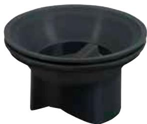
Schlüter-KERDI-DRAIN-R 10 GT ist ein Geruchsverschluss mit Silikon-Trockenklappe für alle 10 x 10 cm Rost-/Rahmen-Sets. Er kann bei selten genutzten Ablaufsystemen (z. B. in Ferienwohnungen) anstelle des serienmäßigen Geruchsverschlusses eingesetzt werden und verhindert eine Geruchsbildung infolge der Austrocknung der Geruchsverschlusseinheit. Mit einer Abflauleistung von mind. 0,4 l/s kann er dort auch dauerhaft die serienmäßige Geruchsverschlusseinheit ersetzen.
