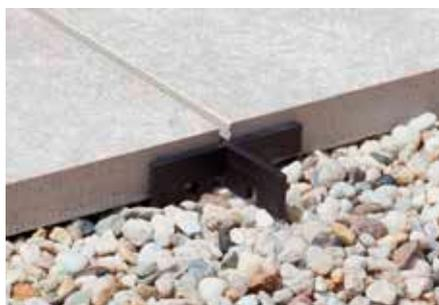
Schlüter-TROBA-ZFK sind Fugenkreuze für ein gleichbleibendes Fugenbild bei der losen Verlegung von Keramikelementen, Naturstein- oder Betonplatten im Kies- oder Splittbett, zum Beispiel auf Schlüter-TROBA. Die Fugenbreite beträgt 3 mm, die Höhe der Kreuze 15 mm. Durch Aufeinanderstecken der Fugenkreuze kann eine Höhe von 30 mm erreicht werden.
