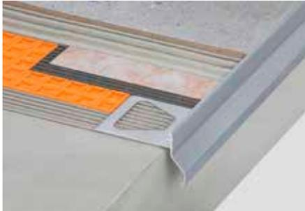
Schlüter-BARA-RKK ist ein T-förmiges Abschlussprofil mit kurzer Tropfkante zur Verlegung auf einen fertigen Gefälleestrich. Es ist für einen Konstruktionsaufbau mit der Verbundabdichtung Schlüter-DITRA ausgelegt. Durch die geschlossene Aufkantung erhält man einen sauberen Fliesenabschluss. (Produktdatenblatt 5.24)
