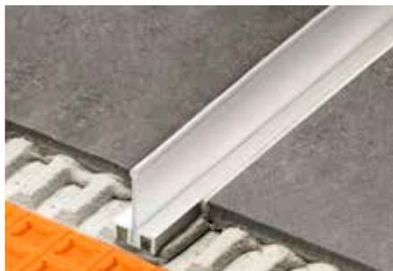
Schlüter-SHOWERPROFILE-WS ist ein zweiseitiges Profil aus eloxiertem Aluminium für den Schwallschutz in bodenebenen Duschanlagen. Das Trägerprofil wird im Zuge der Fliesenverlegung im Kleberbett verankert. Es kann wahlweise mit einer halbrunden oder einer aufrechten geraden Lippe als Schwallschutz ausgestattet werden. Beide Varianten sind für das Befahren mit Rollstühlen geeignet.
