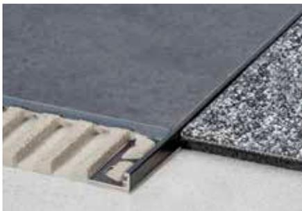
Schlüter-SCHIENE-TS ist ein dekoratives Profil aus Aluminium mit einer speziellen Strukturierung und Textur, die an gängige Fliesendesigns angepasst ist. Sein Abschlusschenkel im 87°-Winkel schützt die Fliesen sicher vor mechanischer Beschädigung. Durch den Fugensteg wird eine definierte Fugenkammer zur Fliese vorgegeben. (Produktdatenblatt 1.1)
