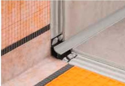
Schlüter-DILEX-HK ist ein Hohlkehprofil aus hartem PVC-Regenerat mit einer Hohlkehle aus Weich-Kunststoff und integrierter Fliesen-kammer für den Wand-/Bodenanschluss. Das Profil erfüllt besondere Anforderungen an Hygiene und Reinigungsmöglichkeiten, wie sie zum Beispiel in der Lebensmittelindustrie oder in Großküchen bestehen. (Produktdatenblatt 4.11)
