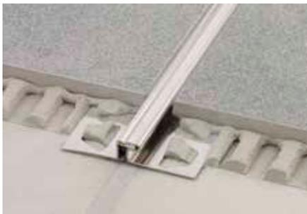
Schlüter-DILEX-EDP ist ein Bewegungsfugenprofil aus Edelstahl, welches durch eine Nut- und Federbindung horizontale Bewegungen aufnehmen kann. (Produktdatenblatt 4.16)
