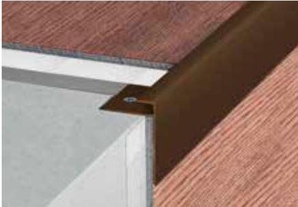
Schlüter-VINPRO-STEP-R ist ein Abschluss- und Kantenprofil für den Einbau elastischer Beläge (z. B. LVT, Designbeläge) auf Treppenanlagen. Der obere Teil des Profils verfügt über einen 10 mm breiten, abgeschrägten Abdeckflansch mit abgerundeter Vorderkante, der dazu dient, die Schnittkante des elastischen Bodenbelags zu verbergen.
