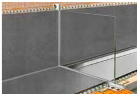
Schlüter-DECO-SG ist ein dekoratives Profil zur Fugengestaltung in Fliesenbelägen. Es bildet wahlweise eine 12 mm bzw. 15 mm breite Schattenfuge aus. Die Fuge eignet sich ideal zur Aufnahme und Fixierung von Glaselementen im Boden- und Wandbereich. (Produktdatenblatt 2.16)
