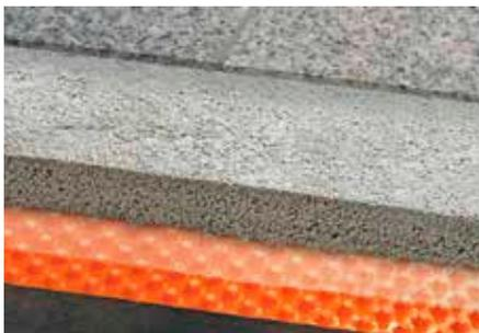
Schlüter-TROBA-PLUS-G ist eine dauerhaft wirksame kapillarbrechende Flächendrainage, die anfallendes Wasser sicher abführt. Die engstehenden als Kegelstumpf ausgebildeten Noppen sind hochbelastbar und mit einem aufkaschierten wasserdurchlässigen Gittergewebe überdeckt. Sie stellen den Belag ganzflächig auf und bilden so einen durchgängigen Drainageraum. Schlüter-TROBA-PLUS 8G ist besonders gut für die Kombination mit Drainageestrichen geeignet. (Produktdatenblatt 7.2)
