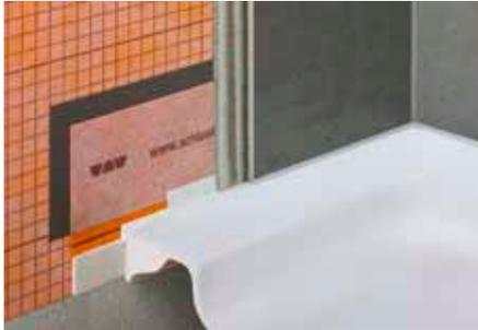
Schlüter-KERDI-TS ist ein Set zur sicheren Andichtung von Einbauteilen wie z. B. Bade- und Duschwannen aus Stahl-Emaile, Acryl oder Mineralguss (gemäß DIN 18534-1) an das Schlüter-KERDI Abdichtungssystem. Es beinhaltet ein Anschluss-Dichtband aus Polyethylen mit beidseitigem Vliesgewebe und selbstklebendem Schalldämmstreifen sowie Installationsmaterial.
