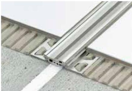
Schlüter-DILEX-BT ist ein Bautrennfugenprofil aus Aluminium mit seitlicher Gelenkanbindung des ineinander verschiebbaren Mittelteils. Somit ist eine dreidimensionale Bewegungsaufnahme möglich. (Produktdatenblatt 4.20)
