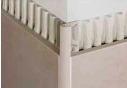
Schlüter-**RONDEC-TS** ist ein symmetrisch gerundetes Profil mit Fugensteg für Wandaußenecken und Belagsabschlüsse aus Aluminium mit einer speziell strukturierten Beschichtung. Durch den Fugensteg wird eine definierte Fugenkammer zur Fliese vorgegeben.
