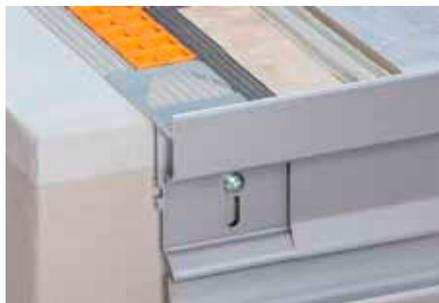
Schlüter-BARA-RTKEG ist ein Randprofil mit Tropfkante zur Verlegung auf einen fertigen Gefälleestrich. Das Profil hat eine Aufnahmevorrichtung zur Befestigung des Rinnensystems Schlüter-BARIN. Es ist für den Konstruktionsaufbau mit der Verbundkopplung Schlüter-DITRA ausgelegt. Durch die geschlossene Aufkantung erhält man einen sauberen Fliesenabschluss.
