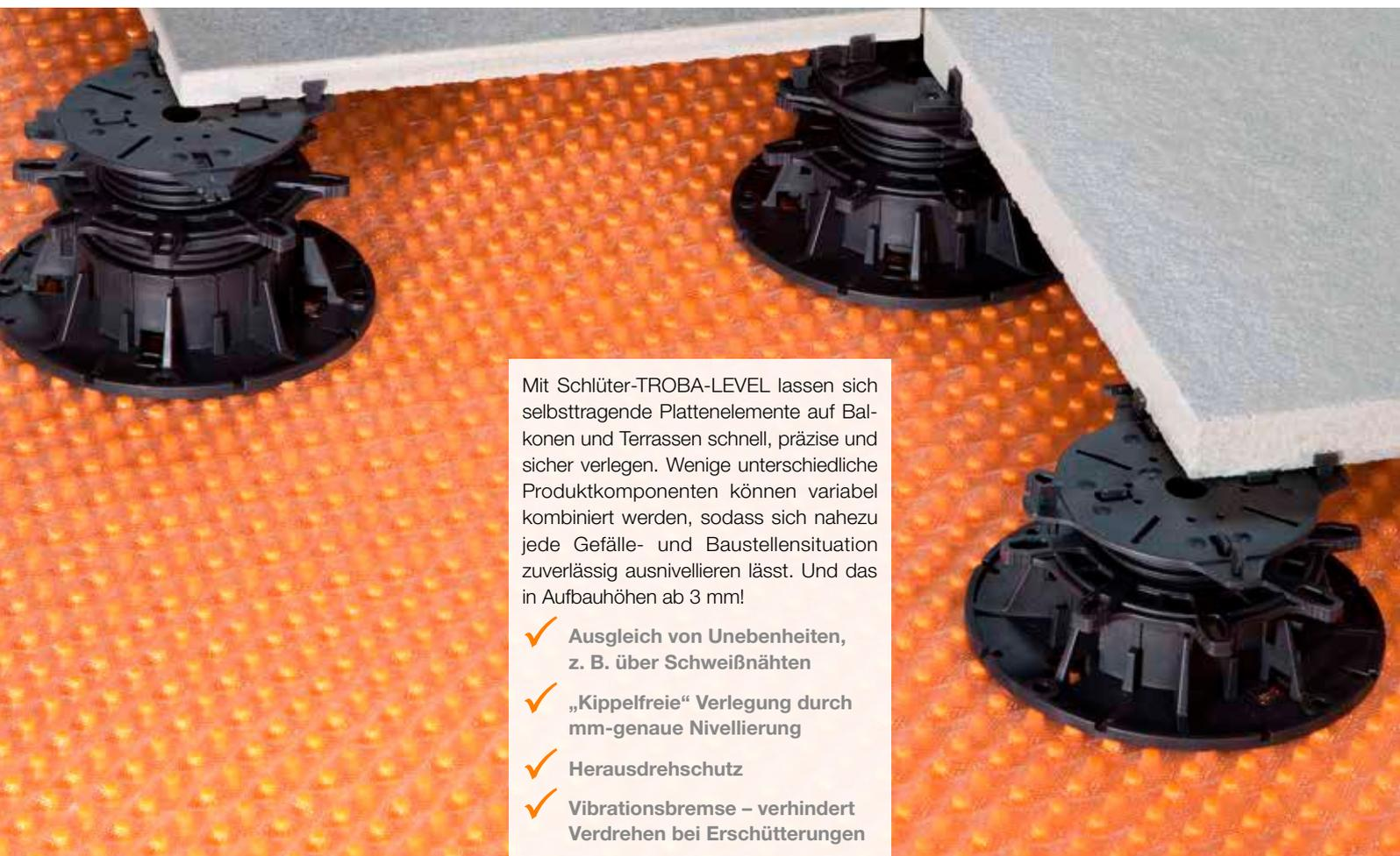
Mit Schlüter-TROBA-LEVEL lassen sich selbsttragende Plattenelemente auf Balkonen und Terrassen schnell, präzise und sicher verlegen. Wenige unterschiedliche Produktkomponenten können variabel kombiniert werden, sodass sich nahezu jede Gefälle- und Baustellensituation zuverlässig ausnivellieren lässt. Und das in Aufbauhöhen ab 3 mm!
