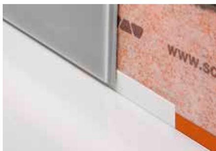
Schlüter-KERDI-CP ist ein kürzbarer Schneidschutz zum Schutz der Abdichtungsebene bei späterer Erneuerung der Silikonfuge. Das knickbare Profil ist individuell einsetzbar und kann direkt im Kleberbett oder im frisch eingebrachten Schlüter-KERDI-FIX montiert werden. (Produktdatenblatt 8.9)
