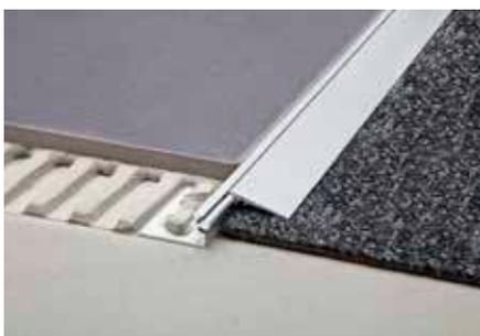
Schlüter-RENO-V ist ein Profil mit variablem Übergangsschenkel zur stufenlosen Verbindung verschieden hoher Bodenbeläge. Durch den Fugensteg wird eine definierte Fugenkammer zur Fliese vorgegeben. (Produktdatenblatt 1.7)
