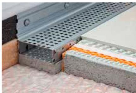
Schlüter-TROBA-LINE-TL ist eine Drainagerinne aus Edelstahl, die bei niedrigen Anschlusshöhen zu Türelementen auf Balkonen und Terrassen eingebaut werden kann, um aufstauendes Wasser zu verhindern. Ebenso kann sie als Flächendrainagerinne verwendet werden.
