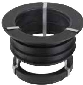
Schlüter-KERDI-DRAIN-ZBS ist eine Durchgangsdichtung mit Brandschutz-Funktion. Sie dient, alternativ zur Vermörtelung, in Verbindung mit dem vertikalen Bodenablauf-Set KD BAV 50 GVB oder der vertikalen Edelstahl-Linientwässerung KLV 50 G2 als Brandabschottung der Kernlochbohrung (Ø 160 mm) und verhindert die Bildung von Schallbrücken. Gilt nur in Verbindung mit KD BS bzw. KL BS als zugelassener Brandschutz.
