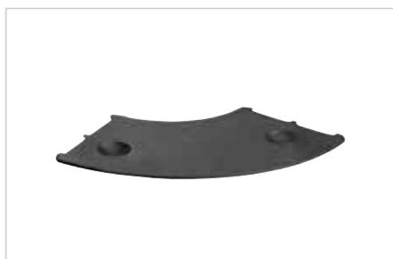
Schlüter-TROBA-LEVEL-AP 1 Ausgleichsplättchen dienen zur Feinjustierung der zu verlegenden Platten in verschiedenen Gefällesituationen. Abweichende Plattendicken, Unebenheiten des Untergrundes oder leichtes Gefälle können bis zu 10 mm pro Plattenecke ausgeglichen werden.
