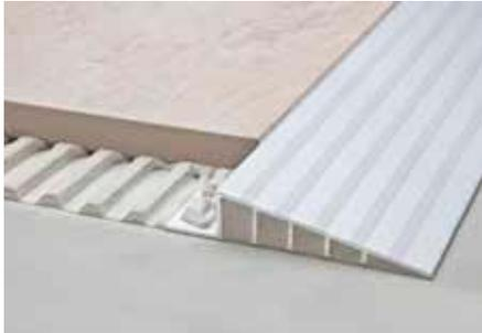
Schlüter-RENO-RAMP ist ein Profil für den stufenlosen Übergang von stark belasteten Fliesenbelägen zu einem angrenzenden niedrigen Belagsmaterial. Durch den Fugensteg wird eine definierte Fugenkammer zur Fliese vorgegeben.
