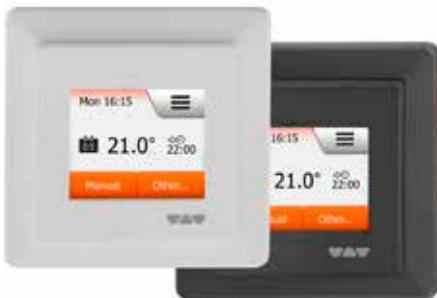
Schlüter-DITRA-HEAT-E-R ist ein Temperaturregler für die Regelung der mit Schlüter-DITRA-HEAT-E elektrisch beheizten Boden- und Wandbeläge. Die Bedienung erfolgt über das 2" (5,1 cm) große Touchscreen-Display. Der Temperaturregler steuert wahlweise die Oberflächen- oder Raumtemperatur nach einem Zeitplan. Ein Reservefühler ist im Lieferumfang enthalten. (Produktdatenblatt 6.6)
