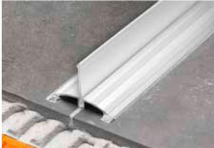
Schlüter-SHOWERPROFILE-WSK ist ein zweiteiliges Profil aus eloxiertem Aluminium für den Schwallschutz in bodenebenen Duschanlagen. Das Trägerprofil wird nachträglich auf vorhandene Beläge aufgeklebt. Es kann wahlweise mit einer halbrunden oder einer aufrechten geraden Lippe als Schwallschutz ausgestattet werden. Beide Varianten sind für das Befahren mit Rollstühlen geeignet. (Produktdatenblatt 14.2)
