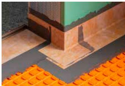
Schlüter-KERDI-CID sind Andichtungs-Sets zur Kapillarunterbrechung am Boden in Tür-Durchgangsbereichen nach DIN 18534. Die Sets unterscheiden sich in der Ausführung für die Türöffnungsrichtung nach innen/außen. Set-Bestandteile sind eine Schlüter-SCHIENE-E mit aufkaschiertem KERDI-KEBA-Dichtband sowie passende KERDI-KERECK-Formteile. Das Profil lässt sich individuell auf das jeweilige Türmaß kürzen. Die Komponenten werden mit KERDI-COLL-Dichtkleber verklebt (nicht im Set enthalten).
