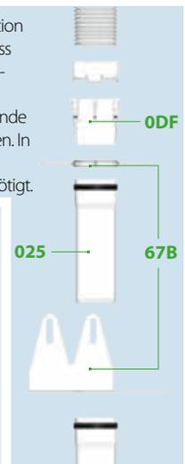
Im Falle einer Installation durch die Wand, muss ein 87°-Winkel an das Stützelement mit Blende (67B) befestigt werden. Ein kurzes Längenelement (025) verbindet den 87°-Winkel mit dem Abgasstutzen.
