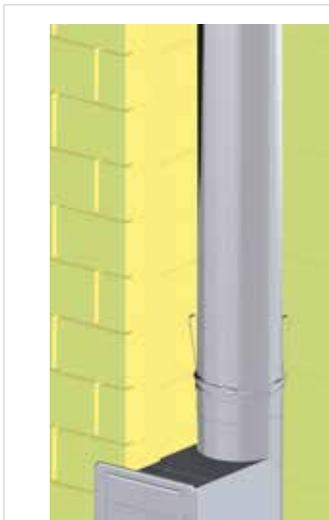
203 Längenelement L= 930 mm mit Ablasschlaufen
