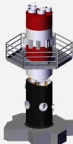
*Freistehender Schornstein mit mehrfach isolierten Innenzüge und tragender Außenwand.*
