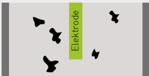
01 Die Feinstaubpartikel strömen mit dem Rauchgas durch den Wärmetauscher und dann in die integrierten E-Filterrohre
