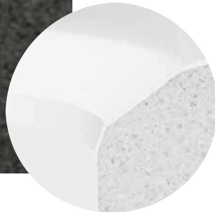
MIRANIT steht für die stabile Verbindung aus circa 80 % natürlichen Mineralien, wie Marmormehl, Sandstein und Quarzsand und circa 20 % eines hochwertigen ungesättigten Polyesterharzes. Aufgrund seiner hervorragenden Fließfähigkeit lässt sich der kunstharzgebundene Mineralwerkstoff auch in geringer Materialstärke in nahezu jede Form bringen.
