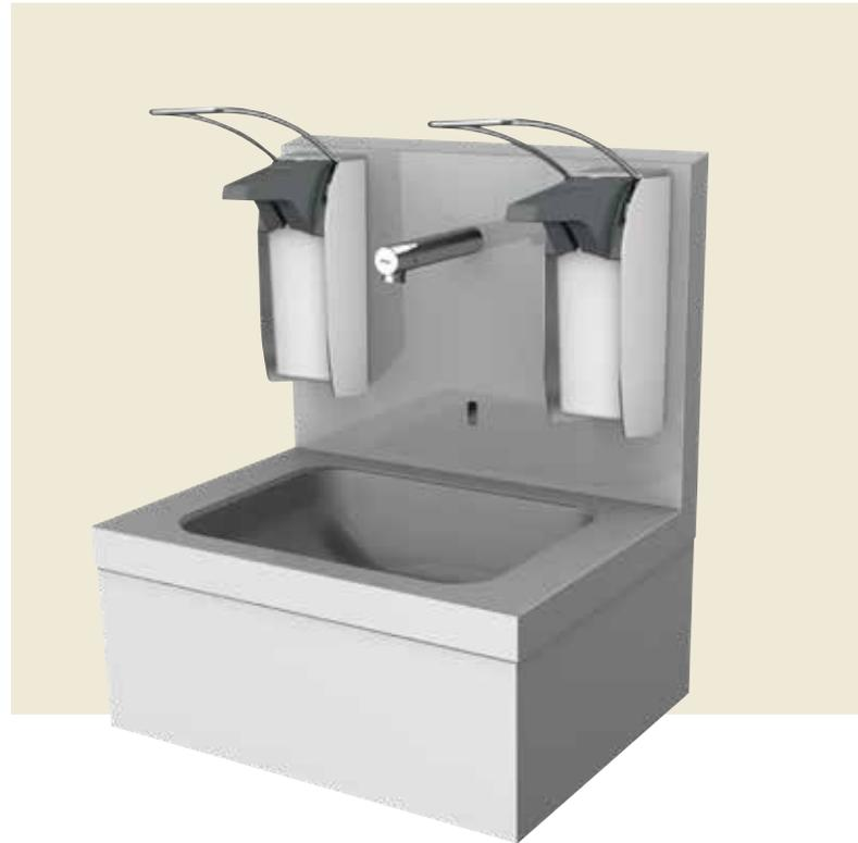
Zum Einsatz kommt der Werkstoff Nummer 1.4301 (AISI 304) nach DIN EN 10088. Die Formel 18/10 steht für bis zu 18 % Chrom und bis zu 10 % Nickel. Diese Verbindung verleiht dem Werkstoff seine besonderen Materialeigenschaften: Er ist unempfindlich gegen Feuchtigkeit und die meisten Säuren und zeichnet sich durch Härte, Zähigkeit, Hygiene sowie hohe Wärme- und Kälteverträglichkeit aus.
