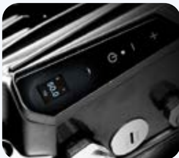
Anzeige für Leistungs- und Fehlerwerte
