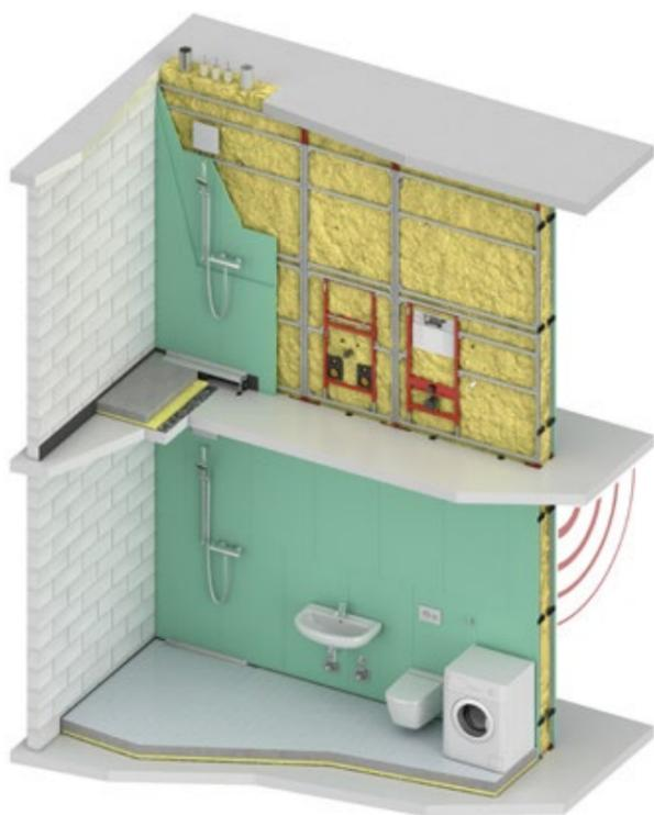
Auf der Baustelle wird die Installationswand nur noch gemäß allgemeiner Bauartgenehmigung (aBG) montiert, beplankt und mit einer mineralischen Einblasdämmung hohlraumfrei verfüllt. Abschließend erklärt der zertifizierte Fachbetrieb für die Einblasdämmung die Übereinstimmung für das Installationsbauteil "TECEsystem-Pro" und übernimmt damit die Gewährleistung.
