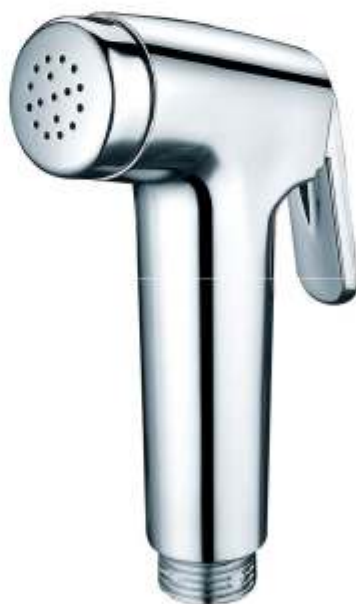
PS070101 镀铬 / CHROME 塑料 / ABS Material 妇洗器 / Shattaf 电镀厚度：镍层2~3um, 铬层0.15um Plating : Cr:0.15um, Ni:2~3um 使用寿命：20000次 LifeTime: 20000 times
