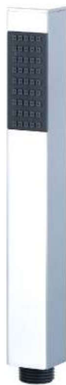
HS110101 镀铬 / CHROME 铜&塑料 / Brass&ABS 花洒 / Hand Shower 电镀厚度：镍层2~3um, 铬层0.15um Plating : Cr:0.15um, Ni:2~3um
