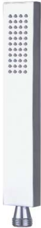
HS090101 镀铬 / CHROME 铜 / Brass 花洒 / Hand Shower 电镀厚度：镍层2-3um, 铬层0.15um Plating : Cr:0.15um, Ni:2-3um
