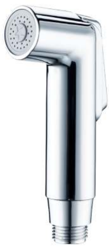
PS450101 镀铬 / CHROME 塑料 / ABS Material 妇洗器 / Shattaf 电镀厚度：镍层2~3um, 铬层0.15um Plating : Cr:0.15um, Ni:2~3um 使用寿命：20000次 LifeTime: 20000 times
