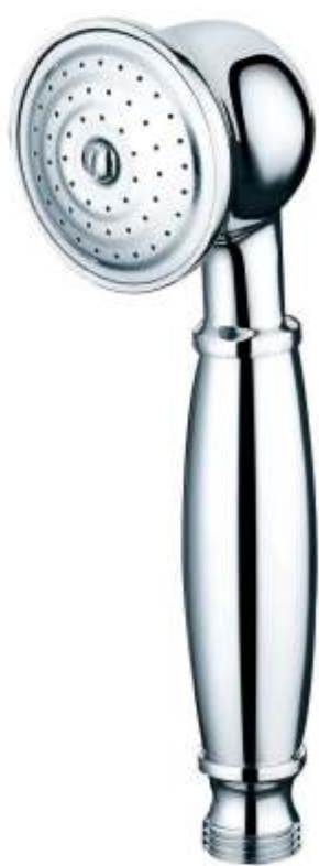
HS020101 镀铬 / CHROME 铜 / Brass 花洒 / Hand Shower 电镀厚度：镍层2-3um, 铬层0.15um Plating : Cr:0.15um, Ni:2-3um
