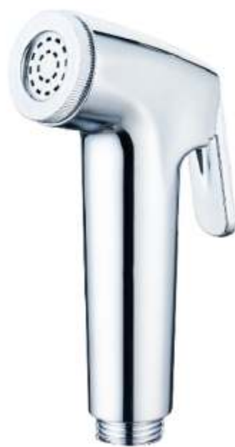
PS060201 镀铬 / CHROME 塑料 / ABS Material 妇洗器 / Shattaf 电镀厚度：镍层2~3um, 铬层0.15um Plating : Cr:0.15um, Ni:2~3um 使用寿命：20000次 LifeTime: 20000 times
