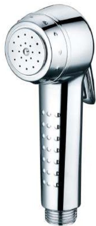
PS170101 镀铬 / CHROME 塑料 / ABS Material 妇洗器 / Shattaf 电镀厚度：镍层2~3um, 铬层0.15um Plating : Cr:0.15um, Ni:2~3um 使用寿命：20000次 LifeTime: 20000 times
