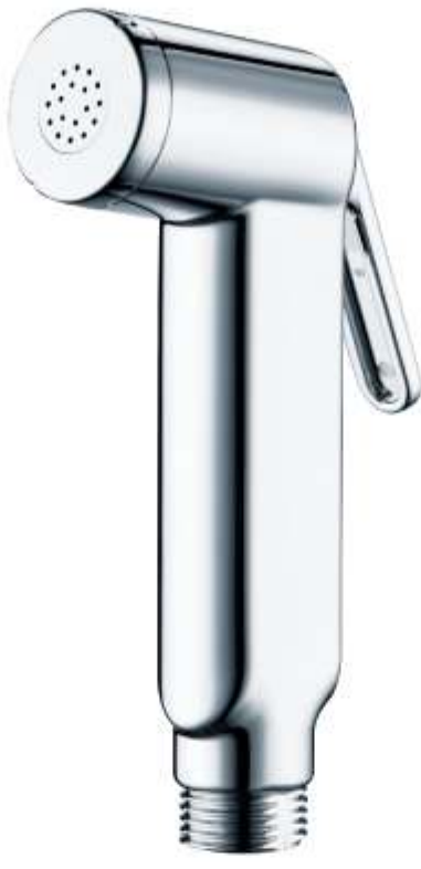
PS430101 镀铬 / CHROME 塑料 / ABS Material 妇洗器 / Shattaf 电镀厚度：镍层2~3um, 铬层0.15um Plating : Cr:0.15um, Ni:2~3um 使用寿命：20000次 LifeTime: 20000 times
