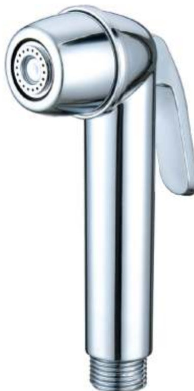
PS190101 镀铬 / CHROME 塑料 / ABS Material 妇洗器 / Shattaf 电镀厚度：镍层2~3um, 铬层0.15um Plating : Cr:0.15um, Ni:2~3um 使用寿命：20000次 LifeTime: 20000 times
