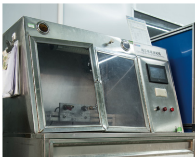
Cartridge Burst Test 阀芯爆破测试
