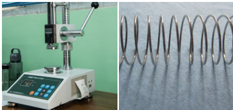
Elasticity tester 弹簧拉压测试机
