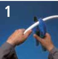
Cortar el tubo.
