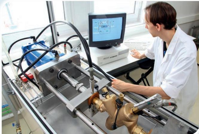
Essai d'étanchéité sur disconnecteur BA
