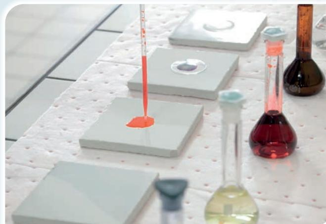
Essai de taches sous produits chimiques
