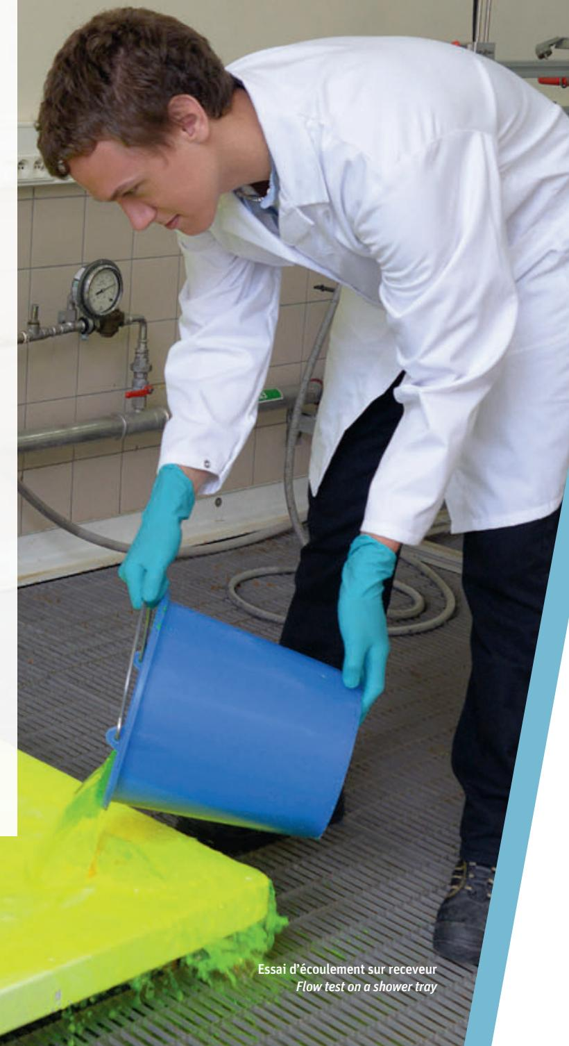
Essai d'écoulement sur receveur
