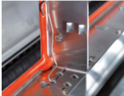
Filterrahmen (Edelstahl V4A -AISI 316- und verzinkt) mit dauerhafter, wasserabweisender Abdichtung (VDI 6022 & VDI 3803 Richtlinie). Filterrahmen geeignet für Filtertypen bis Filterklasse F9 (EN 1886) ePM1 90%.
