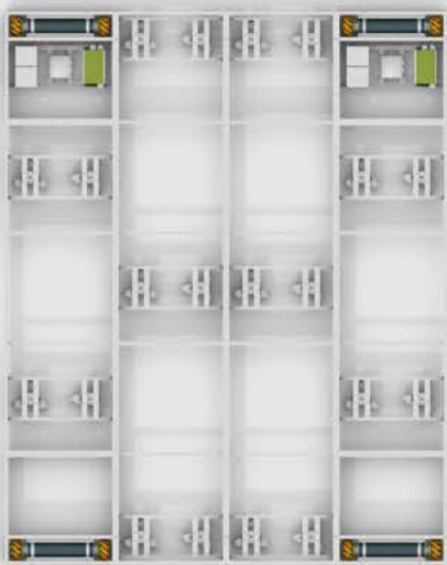
2x Grundmodule mit Achsaueinandersetzung 5 x 4 m
