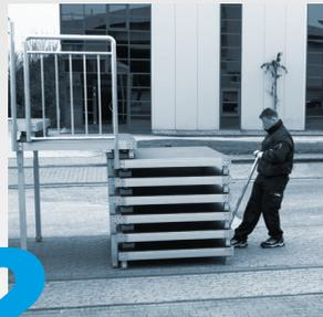
**2** Anheben der untersten Plattform mittels Ausziehstange.
