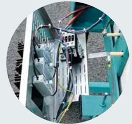
Kompakte, ausklappbare Elektrik in der Ofenrückwand
