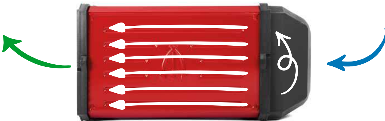
flux d'air horizontal / horizontaler Luftfluss
