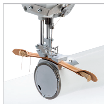
Sewing equipment for making high-quality bag handles Näheinrichtung zum Anfertigen von hochwertigen Taschengriffen
