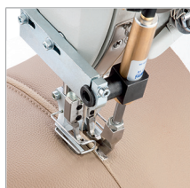
Twin needle welt topstitching Zwei Nadel Keder aussteppen
